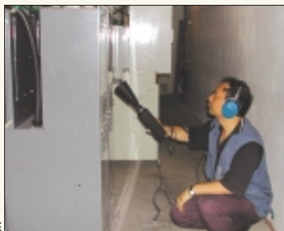
Le contrôle ultrasonore prend alors toute son importance. Dans ces cas l'opérateur, avec un détecteur de défauts ultrasonores de type Ultraprobe 2000, écoute les joints de portes, les aérations et au niveau des vitres plexiglas en face avant des appareillages. La sensibilité de certains appareils ultrasonores a été validée par EDF afin de connaître leur seuil de détection.
