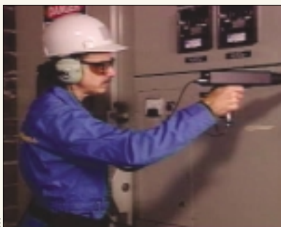
Le contrôle ultrasonore prend alors toute son importance. Dans ces cas l'opérateur, avec un détecteur de défauts ultrasonores de type Ultraprobe 2000, écoute les joints de portes, les aérations et au niveau des vitres plexiglas en face avant des appareillages. La sensibilité de certains appareils ultrasonores a été validée par EDF afin de connaître leur seuil de détection.
